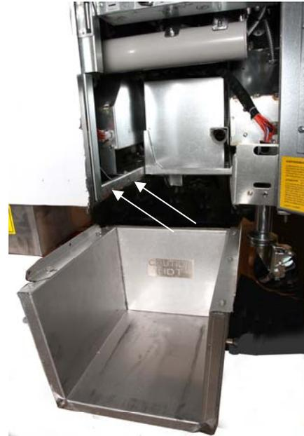
그림 1: 캐비닛에 녹는 단위를 놓고 캐비닛 내부에 제공 된 나사와 함께 첨부 합니다.
